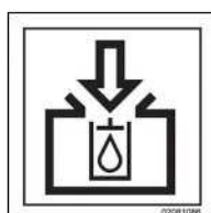
Llenado de depósito de aceite hidráulico
